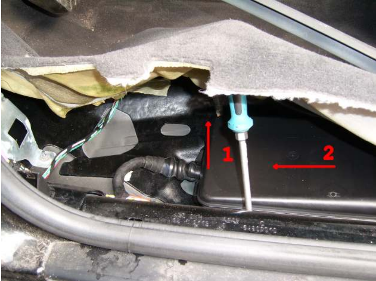
Fahrerseite Einstieg - ZV Steuergerät unter dem Teppich ausbauen
