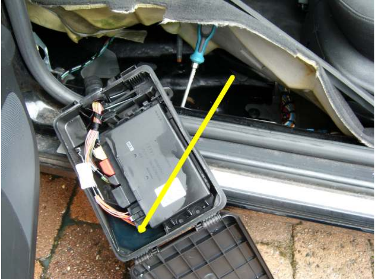
ZV Steuergerät voll Wasser
